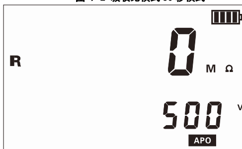
图 9-4 绝缘电阻测量模式
