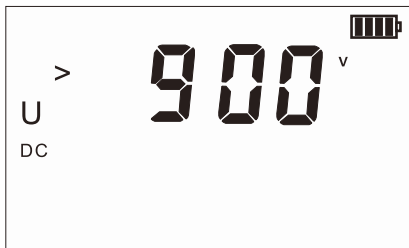
图 11-3 直流电压设置
