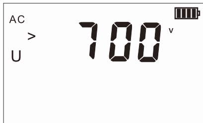
图 11-2 交流电压设置界面
