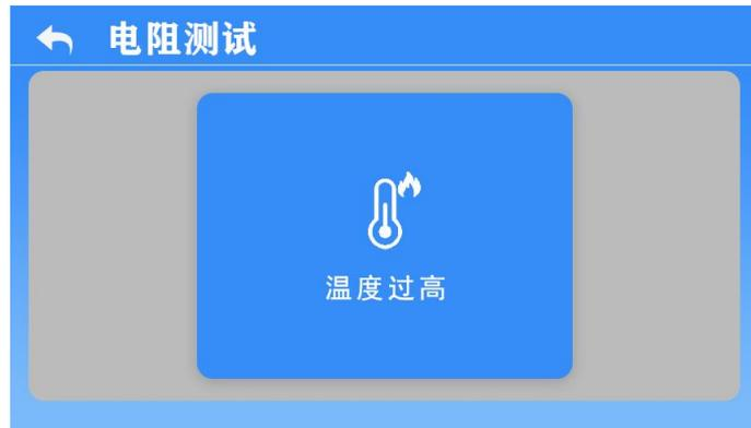
3. 当设备输出端达到危险值后置放了很短的时间又继续大功率测试，电池温度很可能会过热。这时设备将停止输出电流，并显示“过热保护启动停止输出” 点击屏幕上的图标即可返回测试页面。该测试数据也可保存。
