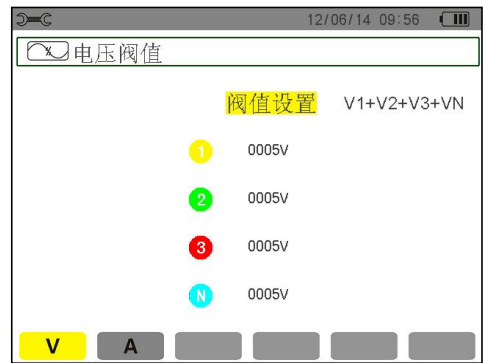
图 5-11 电压阈值设置菜单
