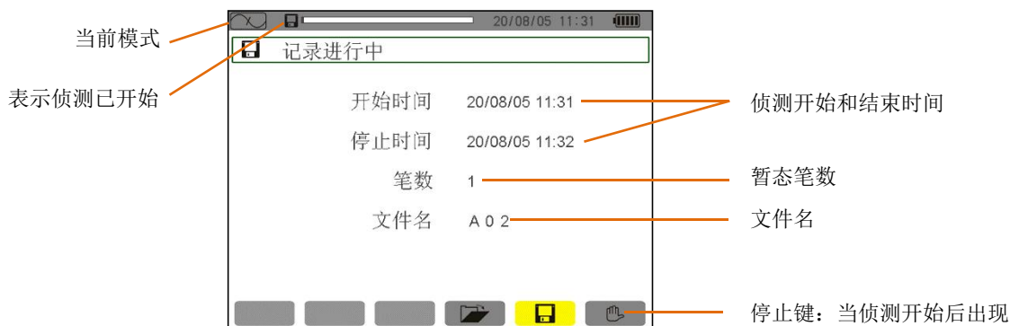
图 6-3 暂态排程进行中
