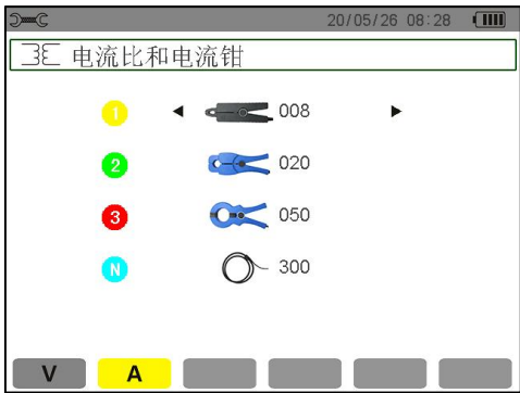
图 5-8 电流钳及变比设置菜单
