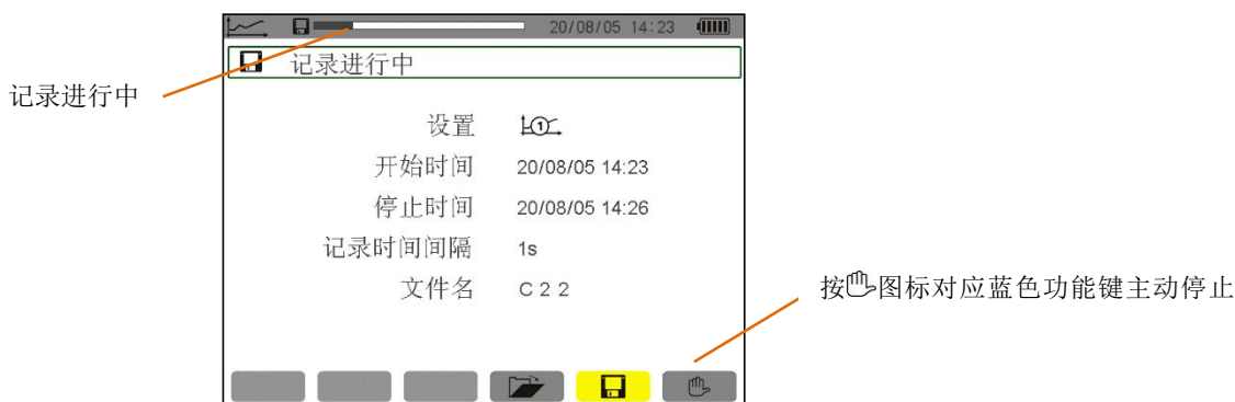
图 10-3 某个趋势图监测的显示屏幕图例
