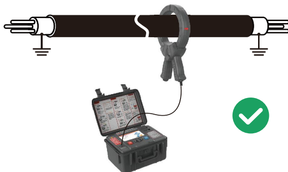
图 5- 15 运行电缆耦合法 1（卡电缆本体）
