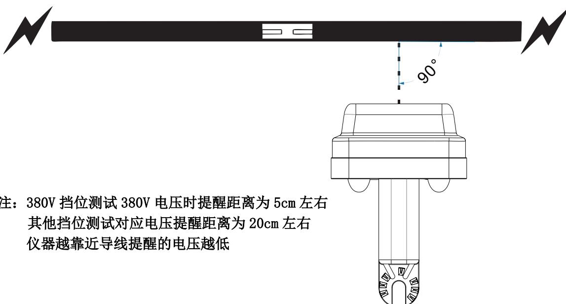
注：380V 挡位测试 380V 电压时提醒距离为 5cm 左右
