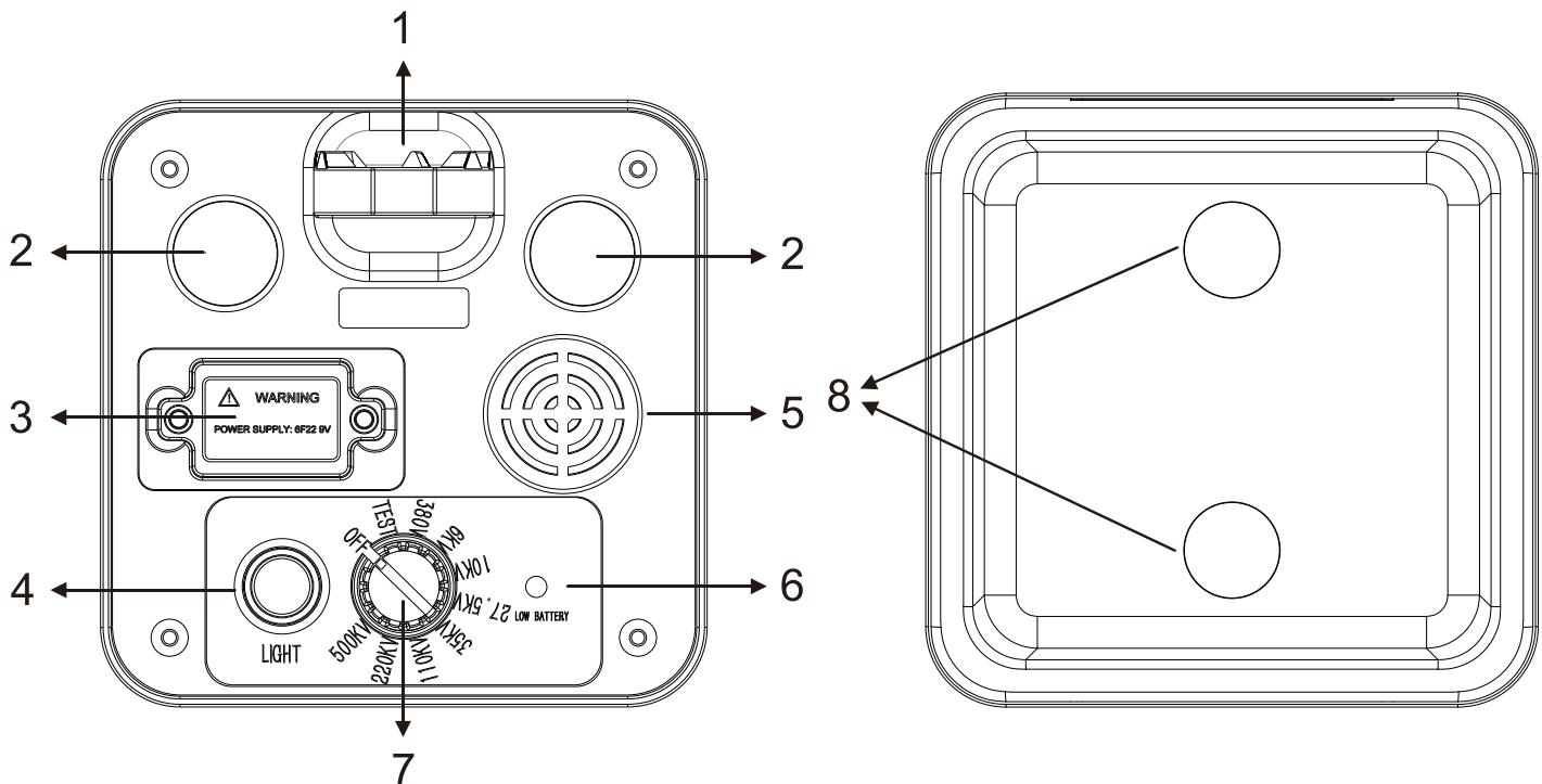
1、绝缘杆接头 2、LED 指示灯 3、电池仓盖 4、照明灯开关
